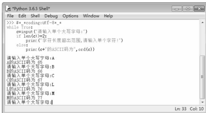
图 3-2 “输出大写字母的 ASCII 状态值”程序运行结果
