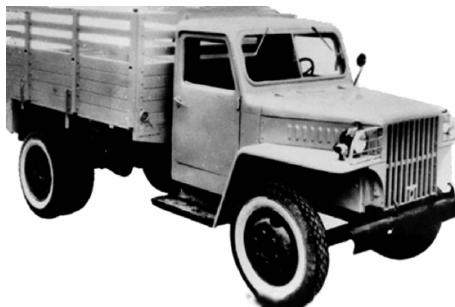
图1-26 NJ130型2.5t载货汽车
