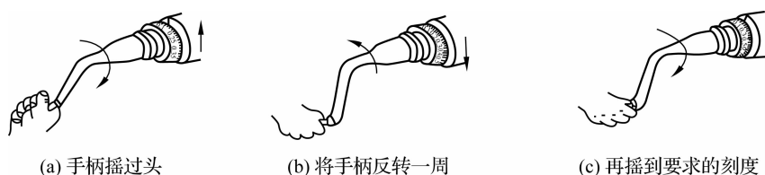
图 1-18 消除刻度盘空转的间隙
