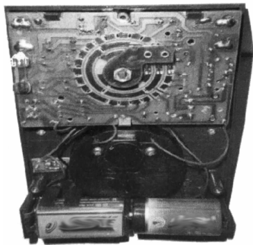
图 2-2 MF47 型万用表的内部结构
