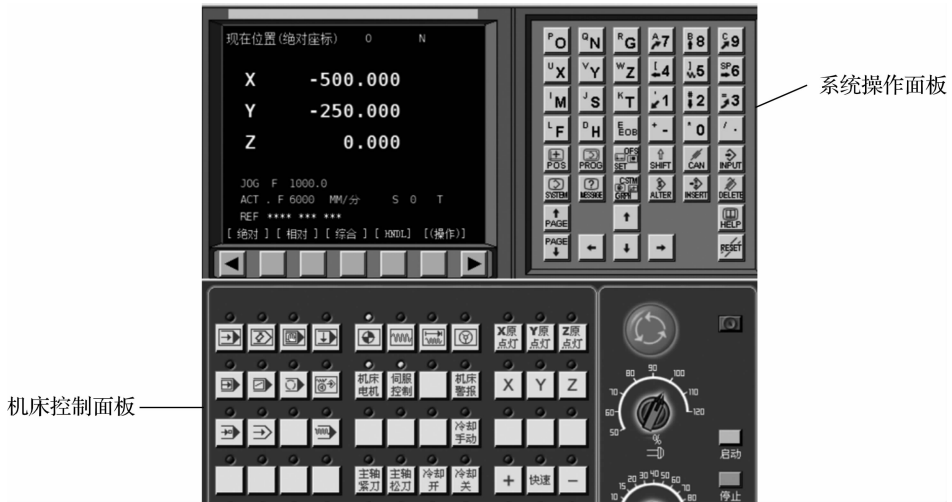
图 1-9 FANUC Oi 铣床数控系统面板
