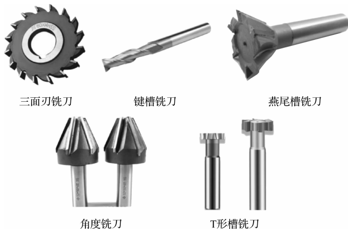
图 1-6 沟槽类加工铣刀
